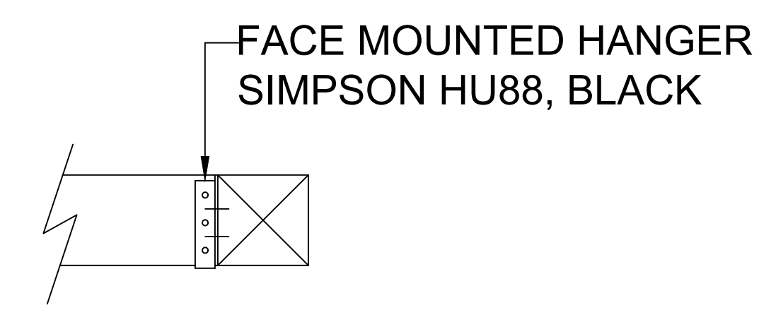
6 R3-HEADER TO EDGE BEAM SCALE: 1" = 1'-0"
